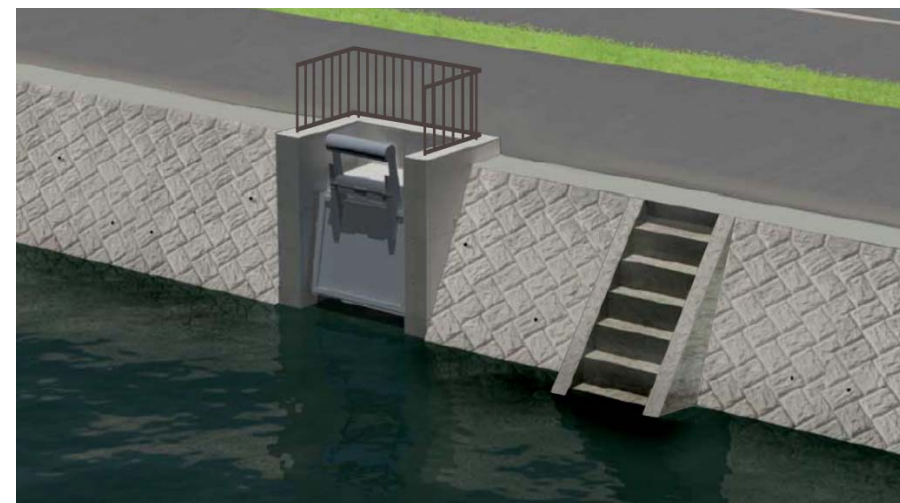
図6 樋門施設等の管理用階段工
