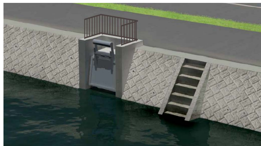
図6 樋門施設等の管理用階段工
