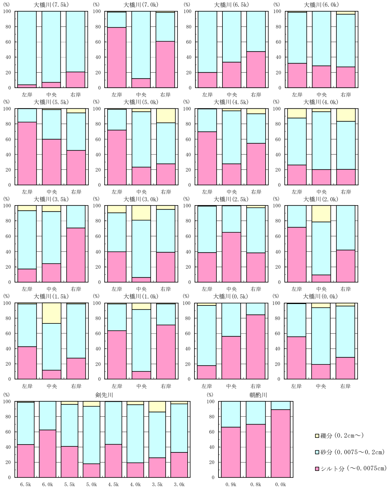
図 6. 1. 2-3 大橋川現況河床の底質の粒径別質量割合
