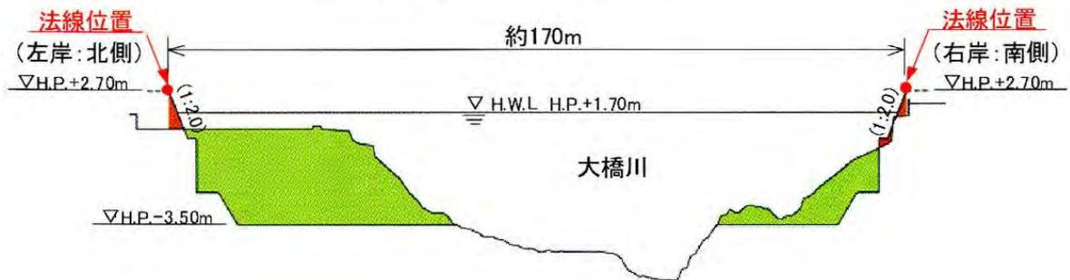
図 2.2-4 計画川幅及び堤防の標準横断形
