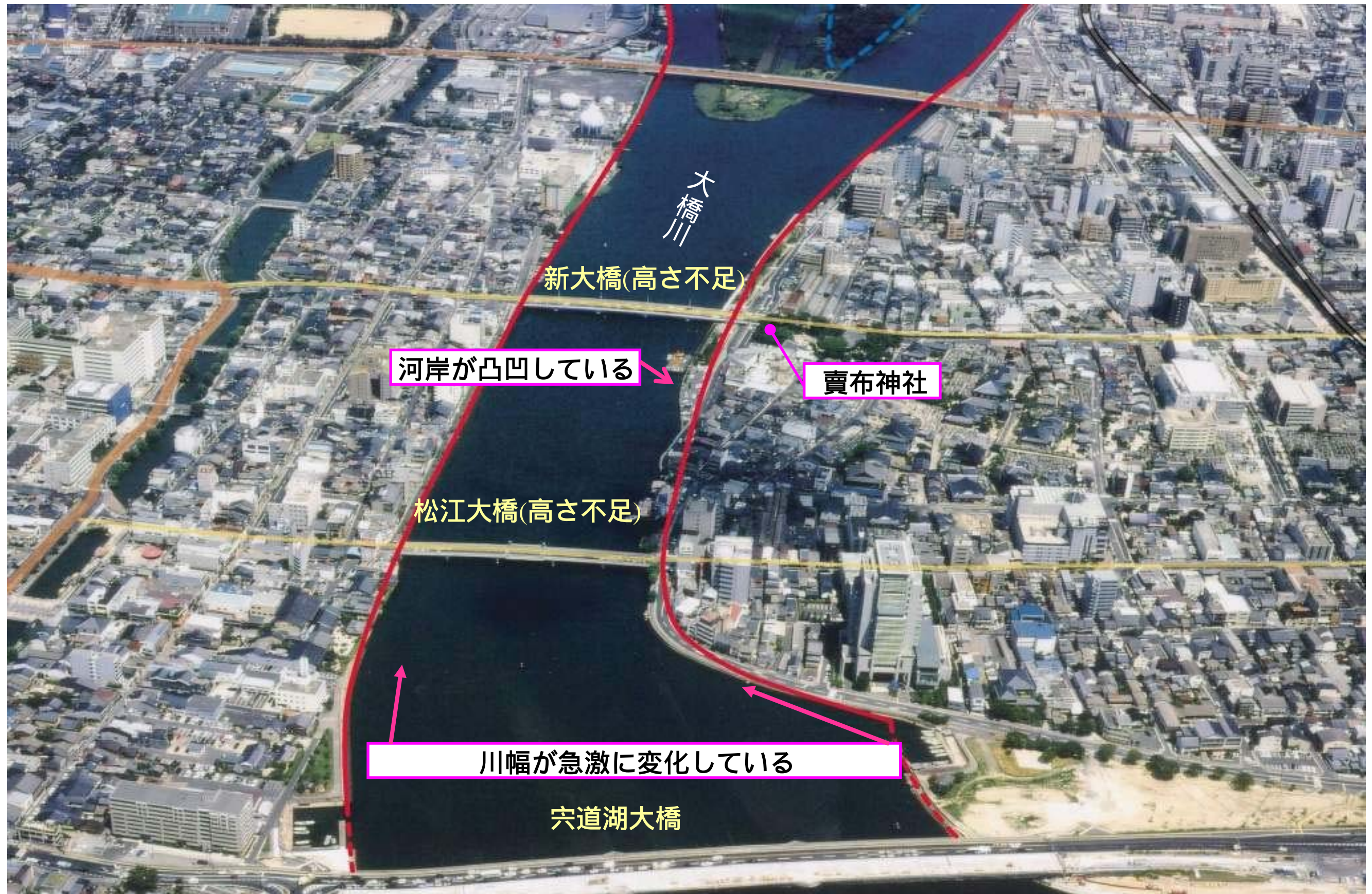
図 2.2.6(1) 大橋川改修案の平面図(上流部)
