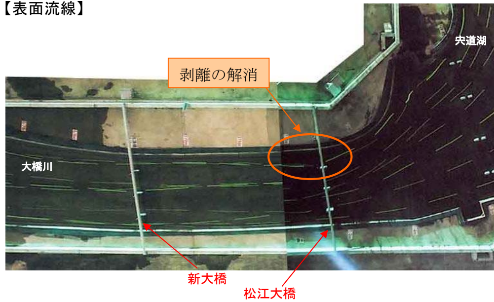
図 1.4.4 H16.12 提示河道の模型実験結果 (ケース 3)
