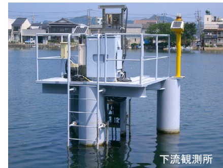
図- 3.6 大橋川流動観測所（底上 10cm に多項目水質計を設置）
