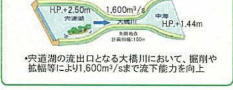
・宍道湖の流出口となる大橋川において、掘削や拡幅等により1,600m<sup>3</sup>/sまで流下能力を向上
