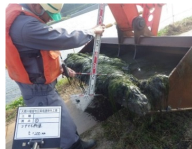
基盤ごと改良したバケットで採取
