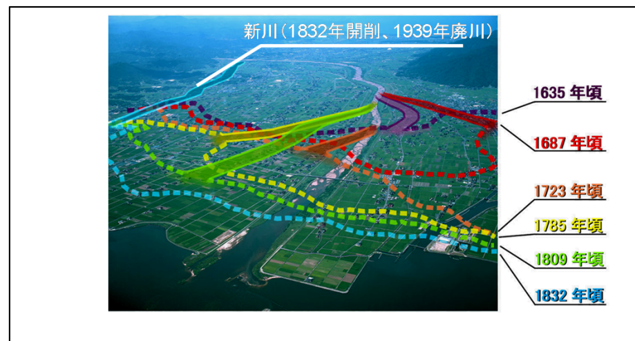
図表1-5-6 斐伊川本川および宍道湖西岸の汀線の変遷
