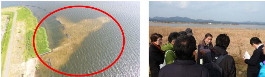
2017年に、斐伊川河口左岸出島地区において、浅場湿地造成を目的とした斐伊川河口の掘削残土の投入を実施した（赤丸部分）。
