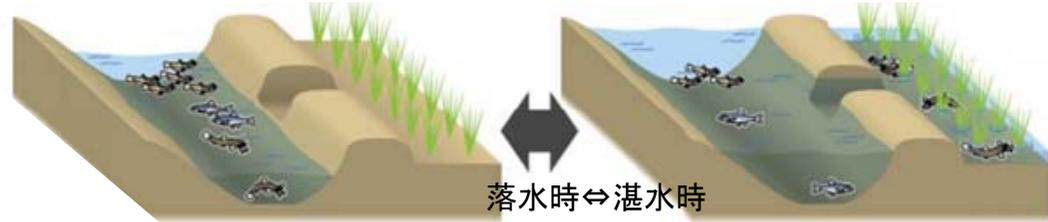
規模について、例えば新潟県佐渡市(「江」の設置を「朱鷺と暮らす郷づくり」認証制度の要件の一つ(選択)としている)では、幅30cm、深さ20cmの深溝(圃場整備のため深く掘れない水田では、幅50cm、深さ10cmでも可)を水田の短辺いっばいに整備することとしている。
