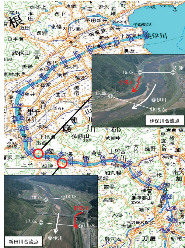
図 5-5 支川合流点処理を実施する箇所
