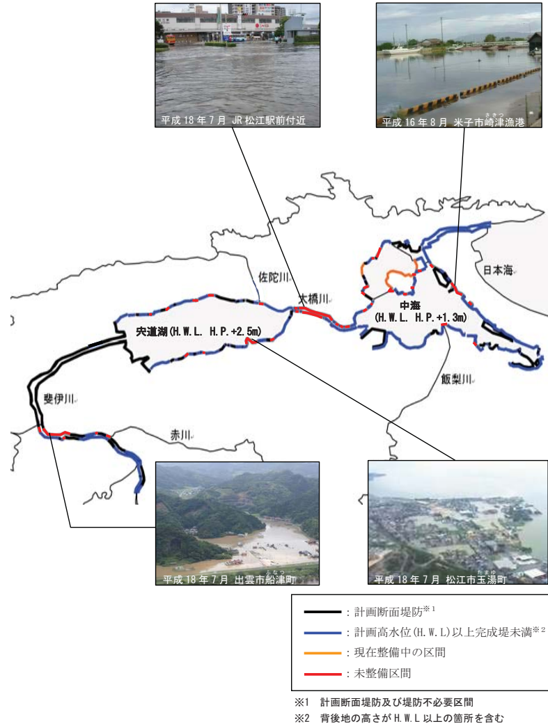
図 3-4 堤防整備状況
