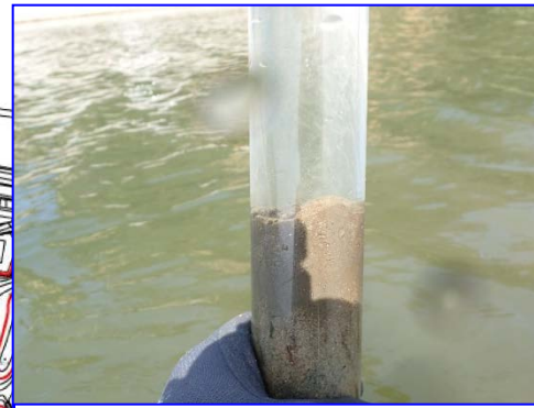
東端突堤の東側には覆砂材が見られる
