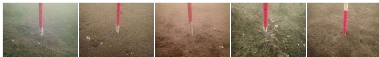
測点0 平均堆積厚 5.0cm 水深2.7m 測点2 平均堆積厚 3.0cm 水深2.7m 測点3 平均堆積厚 2.2cm 水深2.9m 測点5 平均堆積厚 2.8cm 水深2.9m 測点6 平均堆積厚 2.4cm 水深2.8m
