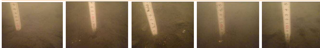
測点0 平均堆積厚 6.3cm 水深2.8m 測点2 平均堆積厚 4.0cm 水深2.7m 測点3 平均堆積厚 5.5cm 水深3.1m 測点5 平均堆積厚 3.4cm 水深3.0m 測点6 平均堆積厚 3.3cm 水深3.0m
