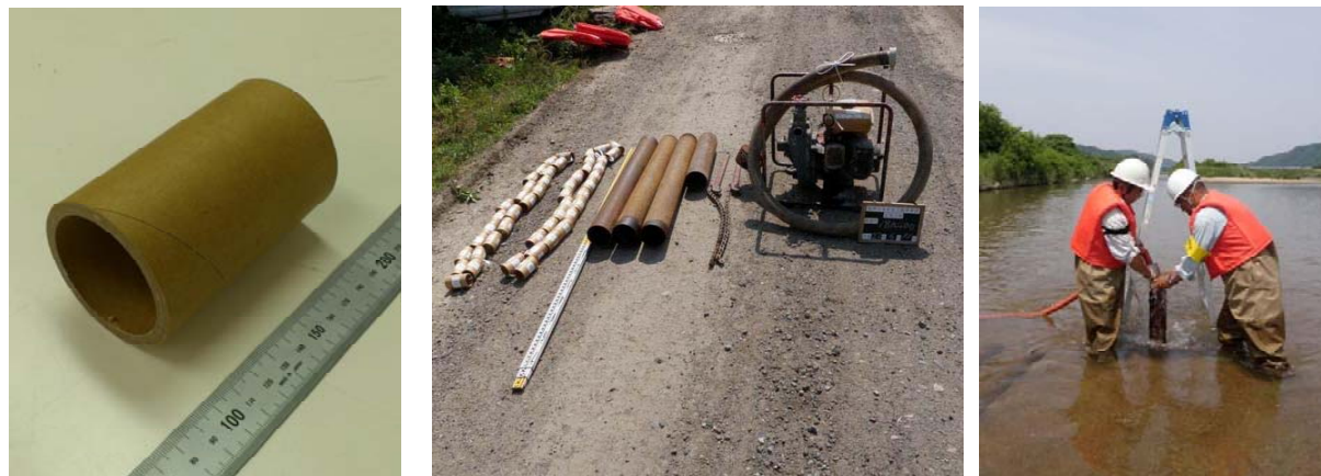
写真－１６ 最深河床高計（紙管）と設置状況
