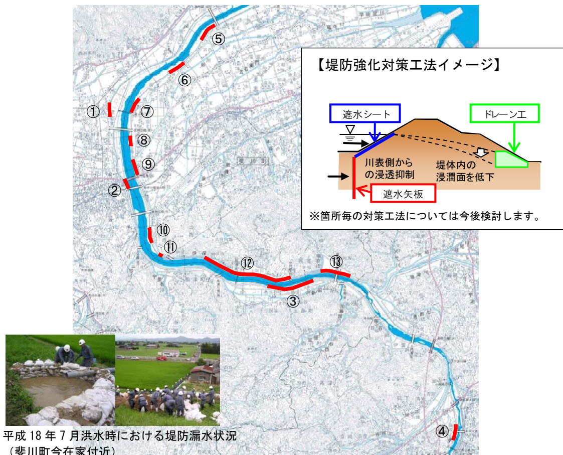
図 5-6 堤防の強化対策を実施する箇所
