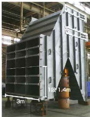
志津見ダムの連続サイフォン式取水設備の一部
