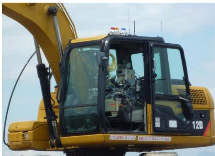
遠隔操縦装置搭載状況
