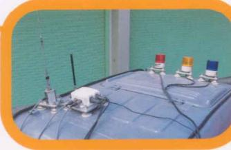
受信装置、受信アンテナ、表示灯の取り付け(マグネット式)
