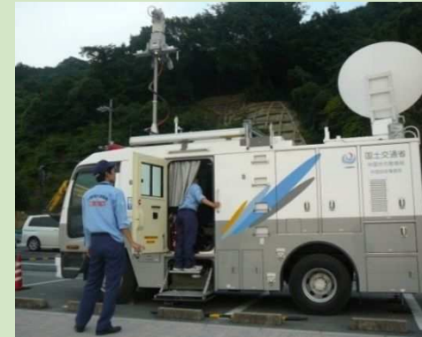
衛星通信車により被災現場の監視
