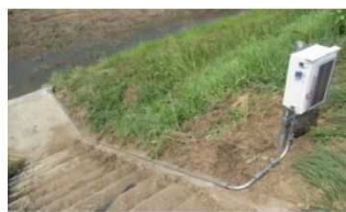
危機管理型水位計の設置例
