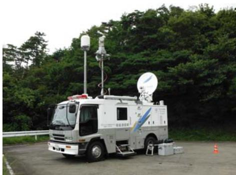
写真24 衛星通信車
