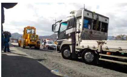
除雪機械による牽引
