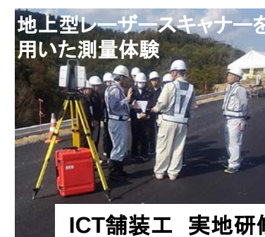
3次元設計データを利用したワンマン測量体験
