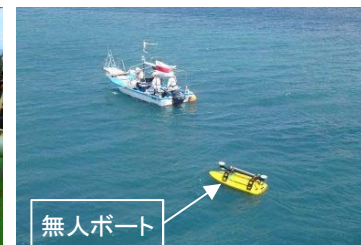
無人ボート(EchoBoat)による測量
