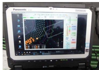
被覆ブロック据付システムモニター
