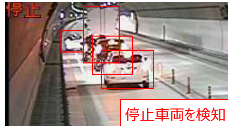
検知イメージ(トンネル内)
