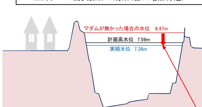
土師ダムの防災操作の効果(吉田地点付近)
