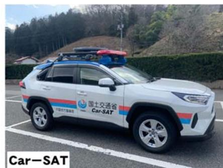
※Car-SAT（移動型衛星通信設備）とは、走行中も衛星追尾（捕捉）が可能な衛星設備の機能と車両の機動力を活かし、被災状況の画像を移動しながらリアルタイム伝送が可能な設備
