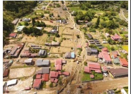
山地流域で発生した土砂の下流河川における堆積と氾濫 (長野県茅野市)
