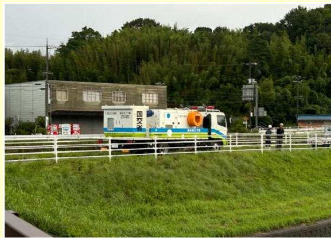
排水ポンプ車の輸送 （岡山県瀬戸内市）
