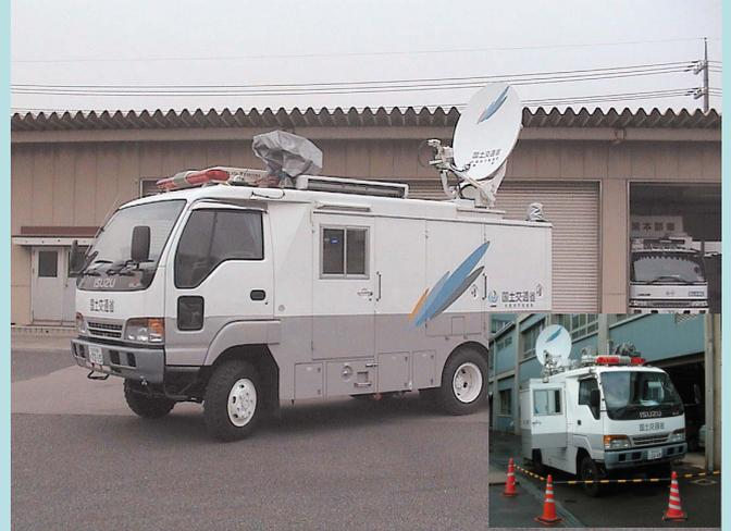
電話回線がパンクして災害現場から情報が送れないとき、衛星回線を利用して災害現場のテレビ映像や通信を行うことができる機械です。
