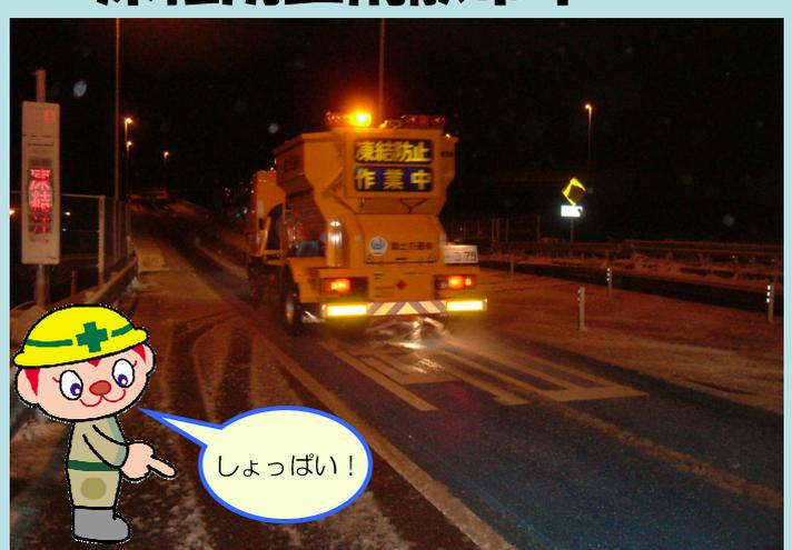
道路の路面がぬれていて、気温が下がった時に、路面が凍らないように凍結防止剤（塩）をまく機械です。
