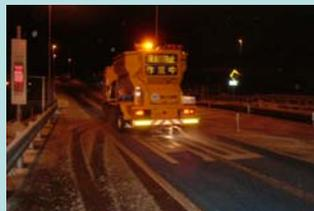
道路の路面がぬれていて、気温が下がった時に、路面が凍らないように凍結防止剤(塩)をまく機械です。
