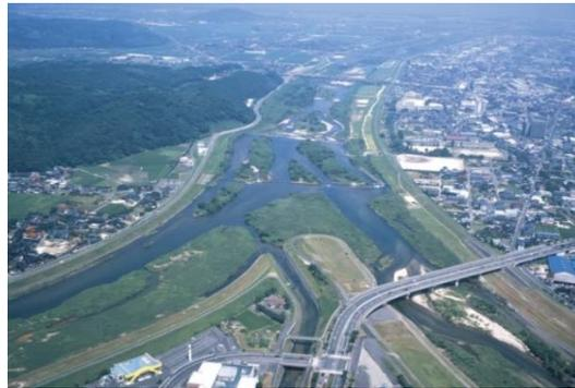
昭和9年9月の室戸台風の大災害が契機となり、同年12月に内務省天神川改修事務所（現在の倉吉河川国道事務所）は開設されました。天神川水系の治水計画は、再び室戸台風の惨事を繰り返さないように、この室戸台風の降雨相当を計画高水流量と定め、小田地点における計画高水流量を3,500m<sup>3</sup>/sとし、堀削、築堤を重点に改修工事を進め現在に至っています。平成18年4月24日には、天神川水系河川整備基本方針が決定され、これに基づき段階的に整備する内容を定めた河川整備計画が平成22年3月5日に策定されました。
