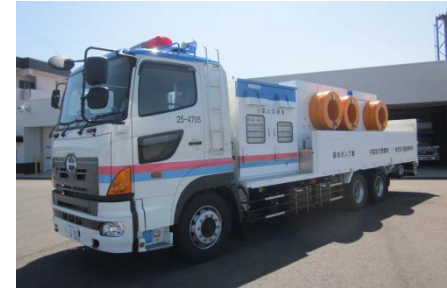
排水ポンプ車 (30m³/分揚程20m)
