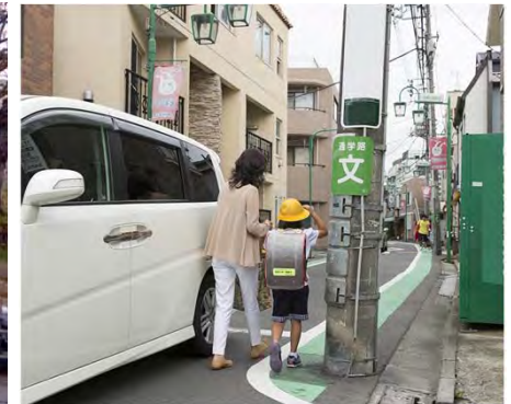
<歩行の支障となる電柱の事例>
