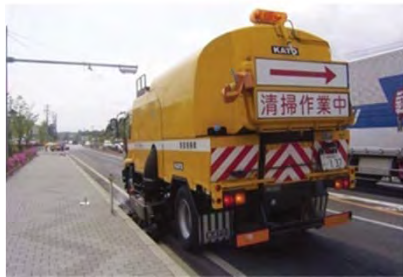
▲路面清掃車による路面清掃
