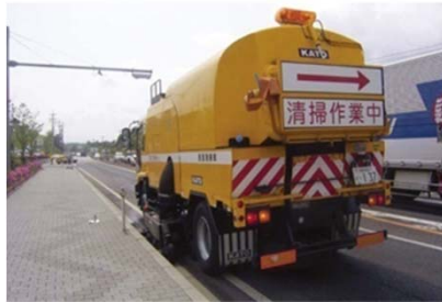
▲路面清掃車による路面清掃
