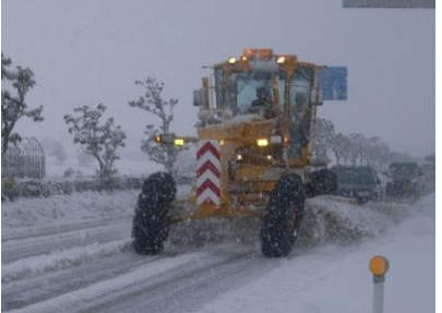
▲ 除雪グレーダーによる除雪作業
