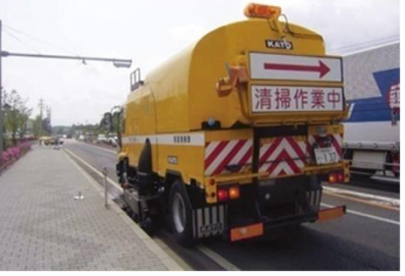
▲ 路面清掃車による路面清掃
