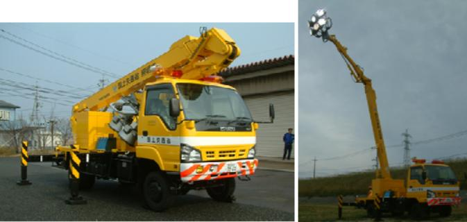
照明車は、災害現場で夜間作業を行うときに出勤して現場を照らす機械です。屈伸ブーム式のため、どんな場所でも照らせる利点があります。また、他の機械に電気を供給する事も出来ます。
