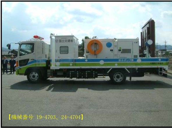
① 排水ポンプ車(30m 3 /min)超軽量型
