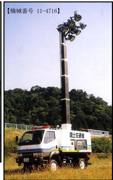
④ 照明車(ポール式) (2kw×6灯)
