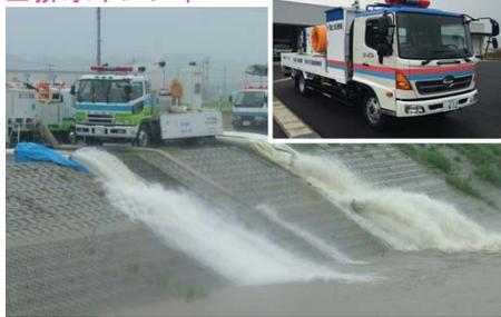
洪水で浸水した箇所へ急行し、車載のポンプにより河沼などに迅速に排水します。1分間でドラム缶150本分の水を排水することができます。
