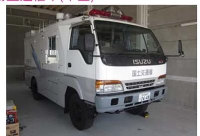
災害等で通信機器が不通になった所でも衛星回線を利用して災害現場の映像等を防災基地へ送信することができます。
