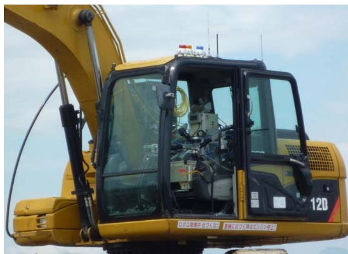
遠隔操縦装置ロボット搭載状況
