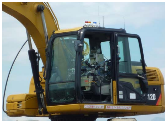
遠隔操縦装置搭載状況
