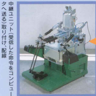
アクチュエーションユニット(走行レバー操作)の取り付け
