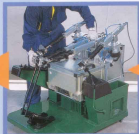
アクチュエーションユニット(走行レバー操作)の取り付け
