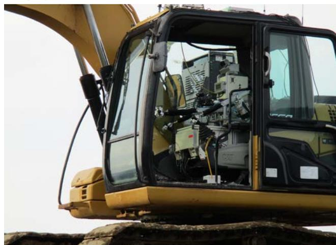
遠隔操縦装置搭載状況
