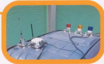
受信装置、受信アンテナ、表示灯の取り付け(マグネット式)
