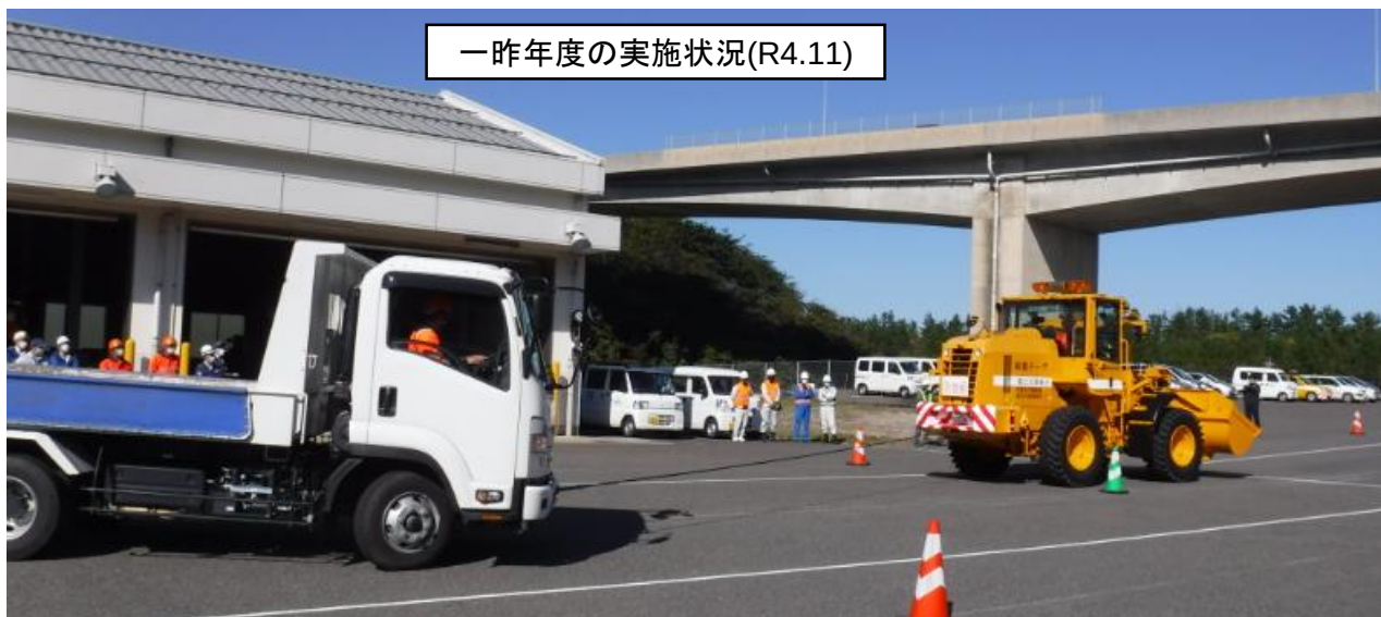
除雪機械による車両移動の状況
