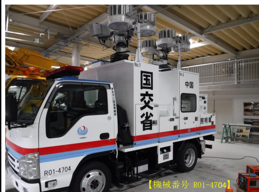
⑤ 照明車(ポール式) (LED灯10m級)
