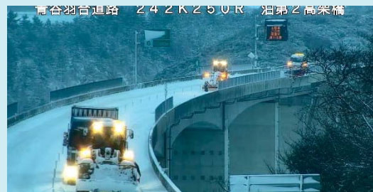
除雪ドーザによるスタック車両牽引 (山陰道 青谷羽合道路)
