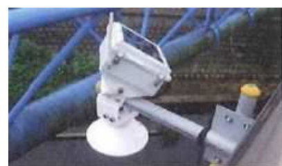
低コスト型水位計の設置例
