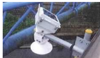
低コスト型水位計の設置例
