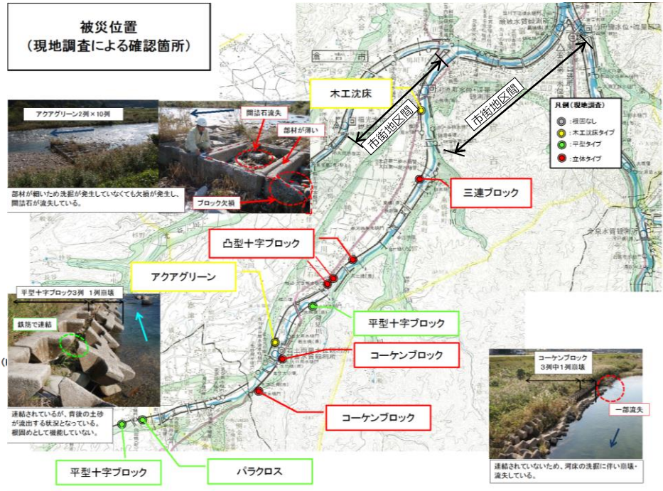
平成23年9月洪水による根固め工の被災状況 (平成25年度調査)
