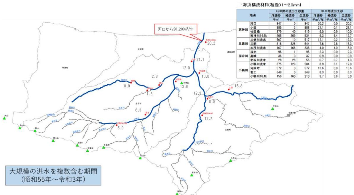
図 5-16 土砂動態マップ (海浜構成材料 : 粒径 0.1~2.0mm)
